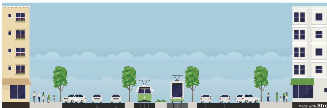
FIGURA 105 SECȚIUNE BULEVARDUL REVOLUȚIEI (SEGMENTUL PRIMĂRIE - TEATRU) - EXISTENT
