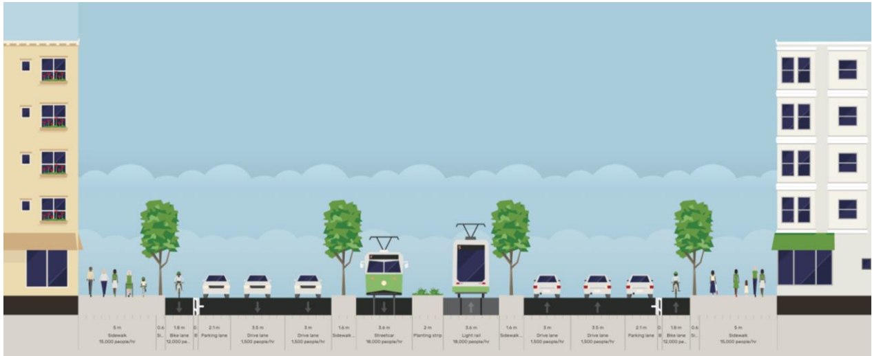
FIGURA 106 SECȚIUNE BULEVARDUL REVOLUȚIEI (SEGMENTUL PRIMĂRIE - TEATRU) - VARIANTA 1
